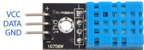
Fig. 7. Adafruit DHT11 Sensor [17]
